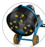
Trois plateaux abrasifs avec système de changement rapide de segments et adaptation automatique de l'outil
