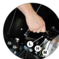
Trasmissione a 3 rapporti per regolare la velocità del disco diamantato
