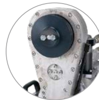
Getriebeschwenkarm mit Schnelltrennflansch für einfachen Blattwechsel
